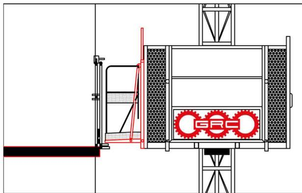
2. Aprire la rampa di sbarco per sbloccare il sistema di apertura della porta al piano scorrevole
